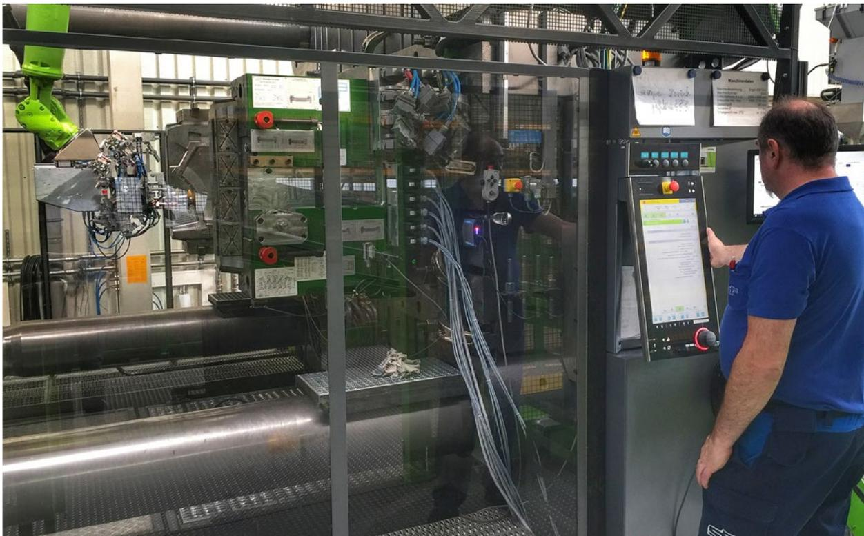
Die Produktion von Stoßfängerüberzügen erfolgt hier auf einer 4.000-Tonnen-Spritzgießmaschine.
