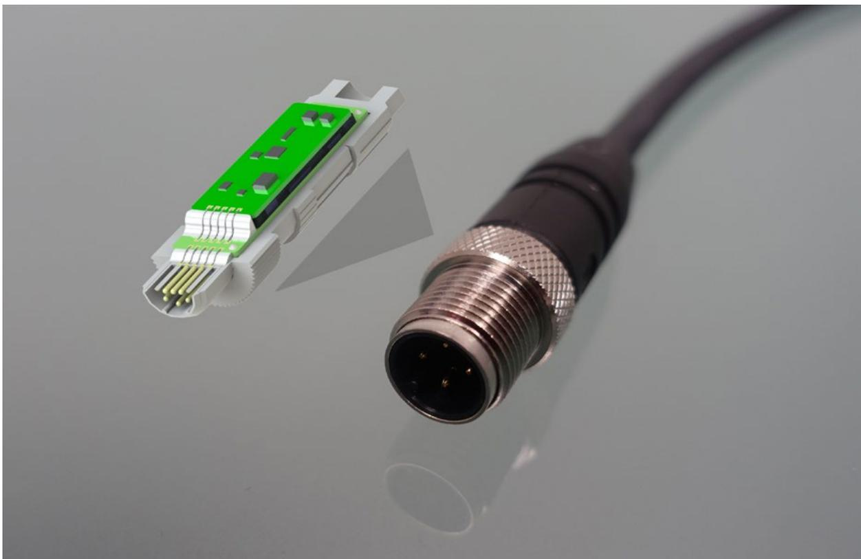
Der Fotoausschnitt zeigt einen intelligenten Steckverbinder mit integrierter Busanbindung für analoge Sensorsignale.
